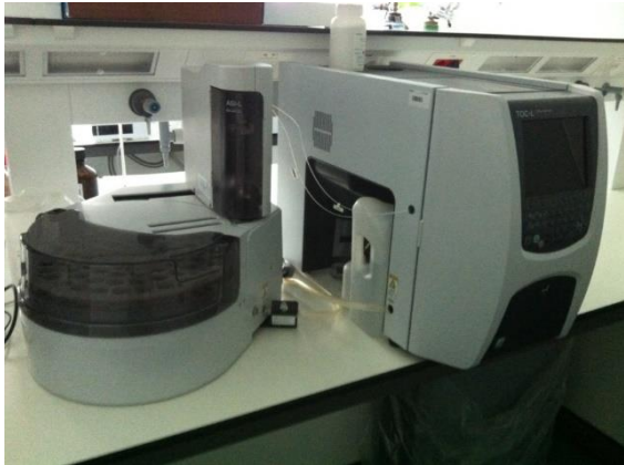
Merilec celotnega ogljika v tekočih vzorcih TOC -Shimadzu
