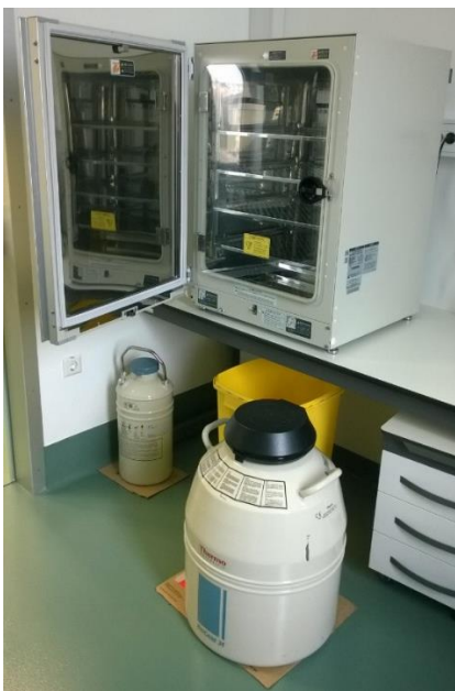
Slika 2: Inkubator CO 2 za gojenje celic, vsebnik s tekočim dušikom za shranjevanje celic, prenosna posoda s tekočim dušikom, vse v FRLA (lastna slika)
