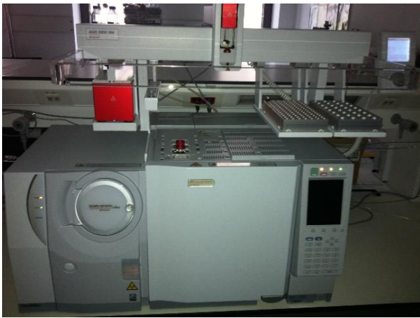
Plinska kromatografija z masno spektrometrijo (GC-MS) - Shimadzu QP2010 Ultra
