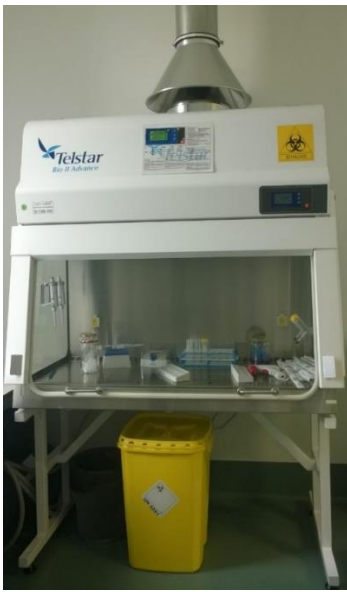
Slika 1: Komora z laminarnim pretokom zraka v FRLA (lastna slika)
