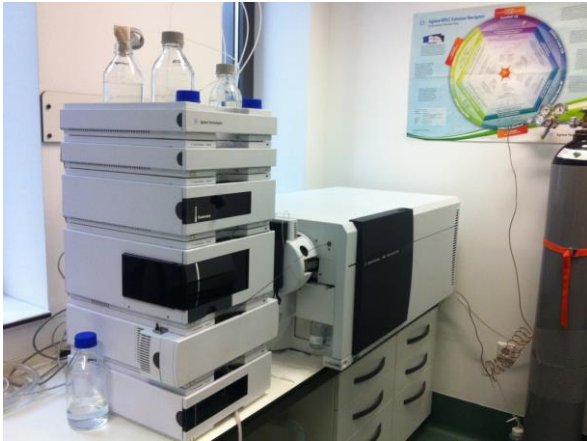
Tekočinska kromatografija z masno spektrometrijo (LC-MS/MS)- Agilent 1200 + 6460 JetStream
