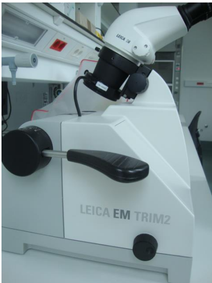
Aparat za brušenje tkivnih vzorcev LEICA EM TRIM2
