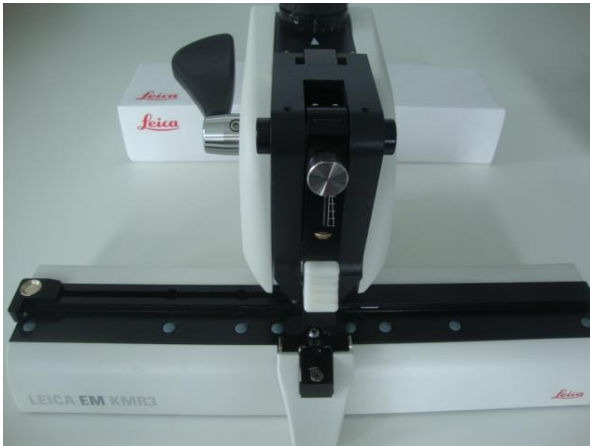
Izdelovalec steklenih nožev LEICA EM KMR3
