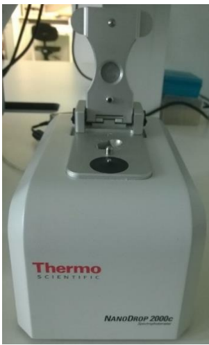
Slika 4: Spektrofotometer UV/VIS za nanos 2 µL vzorcev v FRLA (lastna slika)
