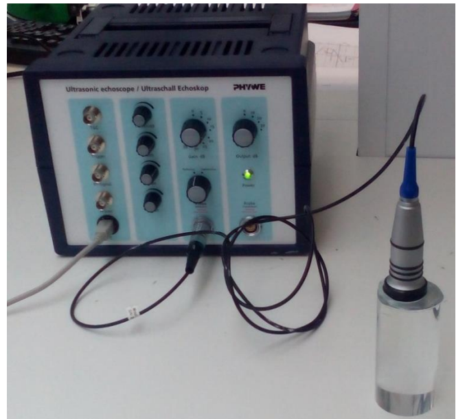
Meritev z računalniškim ultrazvočnim merilnim sistemom.
