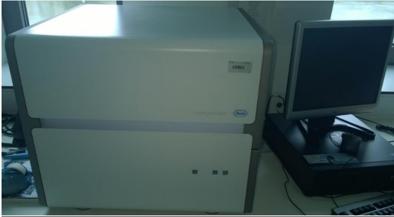
Slika 6: Aparatura za PCR v realnem času v FRLA (lastna slika)
