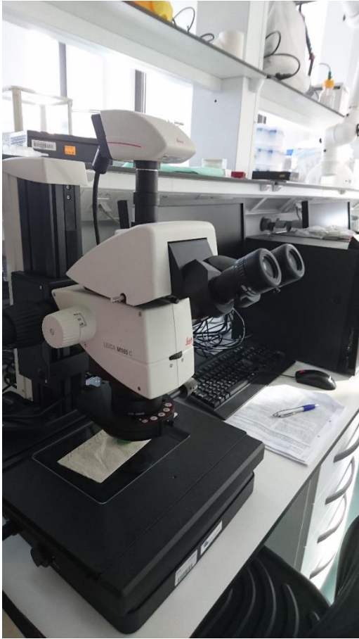
3D stereolupa - mikroskop za 3D objekte s kamero
